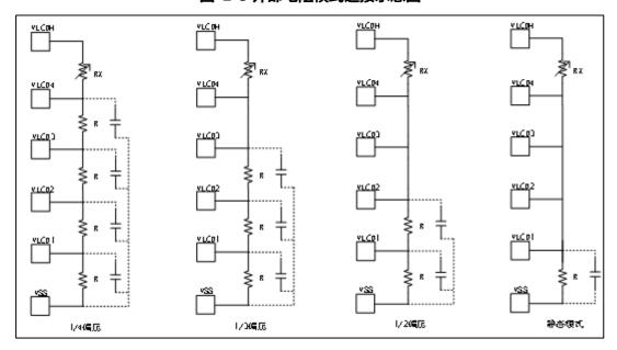
图 2-5 外部电阻模式连接示意图
