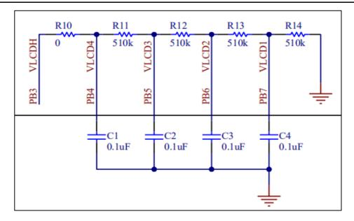
本示例中只为说明如何驱动 LCD 显示屏,故分压方式选择内部电阻分压,且不外接外部电容的方式,此模式下无需外部电路辅助,SEG31-SEG35 对外接口关闭,用作 SEG 口。
