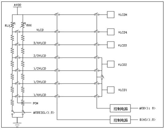
图 2-3 内部电阻分压电路示意图
