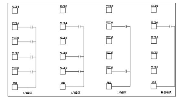
图 2-4 内部电阻模式外接滤波电容示意图
