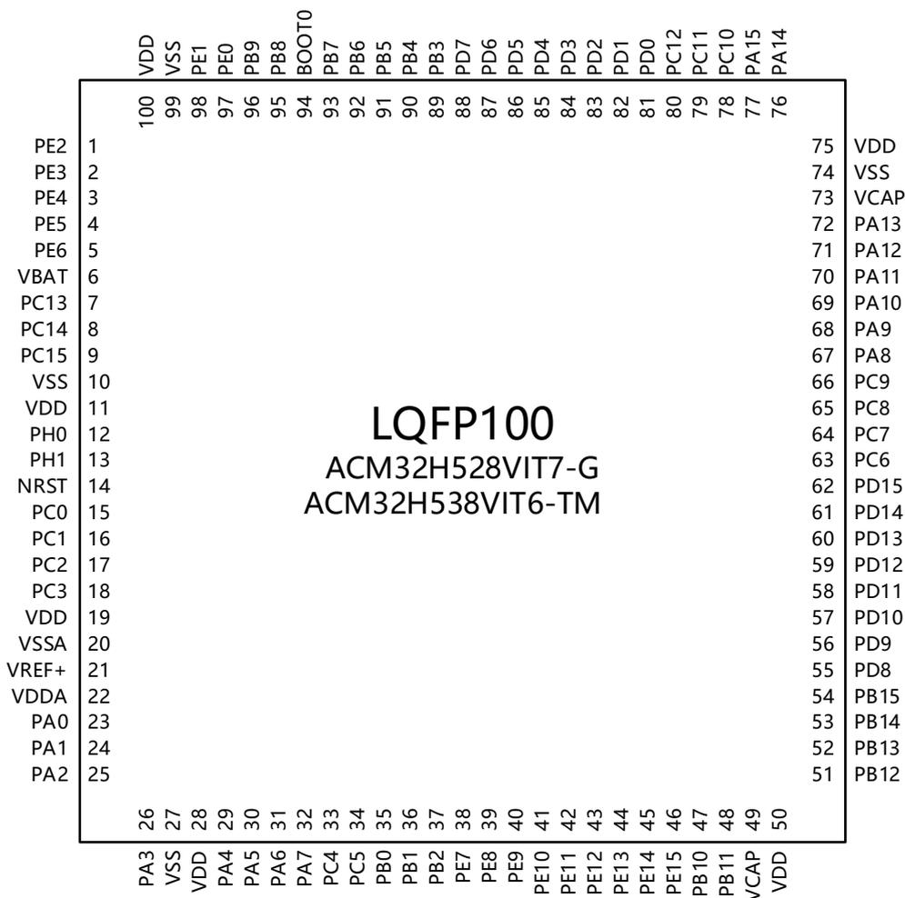
备注：VDDIO2 内部绑定到 VDD；VDD50 内部绑定到 VDD；VDDUSB 内部绑定到 VDD；VBAT 由外部输入；PDR\_ON 内部绑定到 VDD，使能内部 POR。
