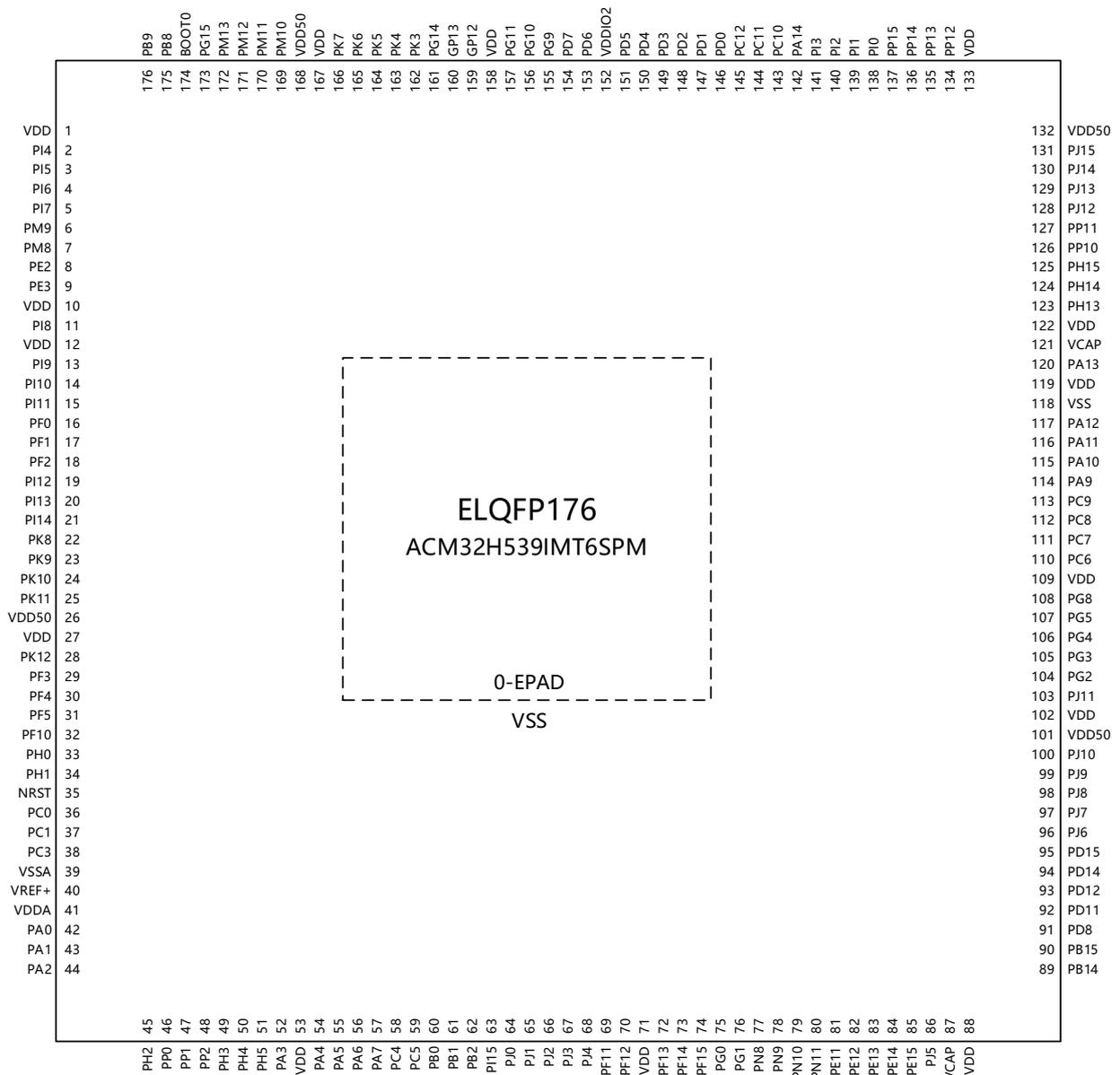
备注: (1) VDDIO2 由外部输入; VDD50 由外部输入; VDDUSB 内部绑定到 VDD; VBAT 内部绑定到 VDD; PDR\_ON 内部绑定到 VDD, 使能内部 POR。
