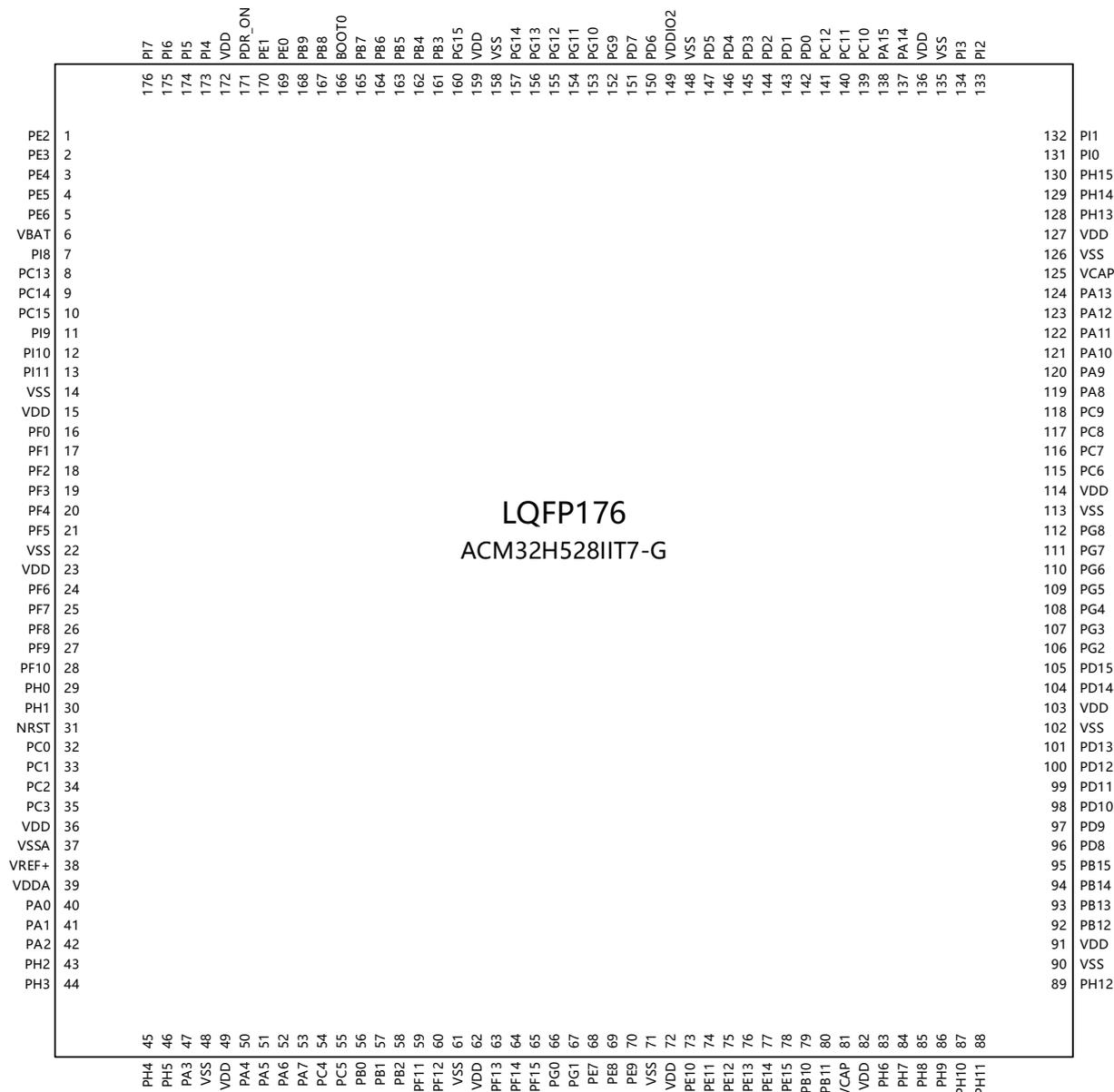
备注：VDDIO2 由用户外部输入；VDD50 内部绑定到 VDD；VDDUSB 内部绑定到 VDD；VBAT 由外部输入；PDR\_ON 由用户选择接 VSS 或 VDD。
